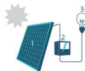
1. Zonnepaneel | 2. Omvormer | 3. Elektrische toestellen
