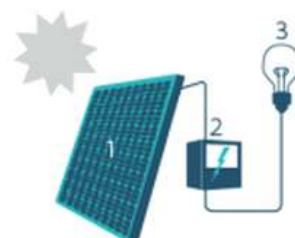
1. Zonnepaneel | 2. Omvormer | 3. Elektrische toestellen
