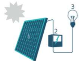
1. Zonnepaneel | 2. Omvormer | 3. Elektrische toestellen
