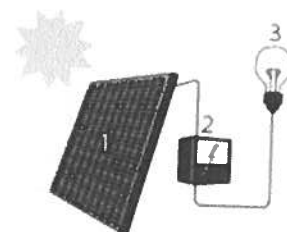
1. Zonnepaneel | 2. Omvormer 3. Elektrische toestellen
