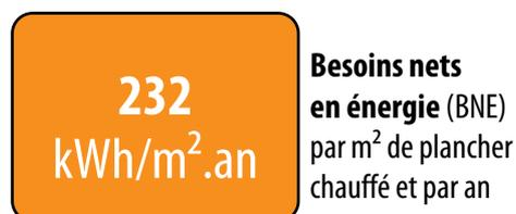
Ces besoins sont les apports de chaleur à fournir par le chauffage pour maintenir constante la température intérieure du logement. Ils dépendent des pertes par les parois selon leur niveau d'isolation thermique, des pertes par manque d'étanchéité à l'air, des pertes par la ventilation mais aussi des apports solaires et des apports internes.
