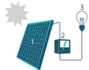
1. Zonnepaneel | 2. Omvormer | 3. Elektrische toestellen
