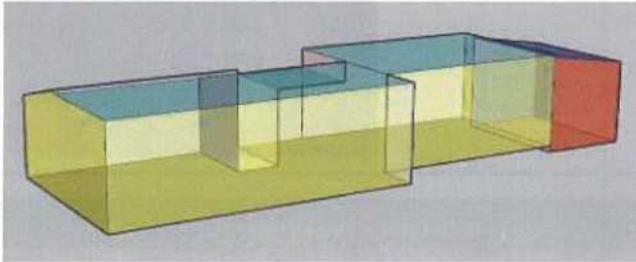
Le volume protégé d'un logement reprend tous les espaces du logement que l'on souhaite protéger des déperditions thermiques que ce soit vers l'extérieur, vers le sol ou encore des espaces non chauffés (cave, annexe, bâtiment mitoyen...). Il comprend au moins tous les locaux chauffés. Lorsqu'une paroi dispose d'un isolant thermique, elle délimite souvent le volume protégé.
