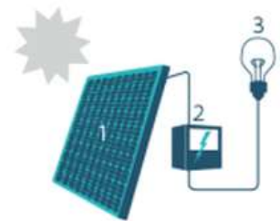
1. Zonnepaneel | 2. Omvormer | 3. Elektrische toestellen
