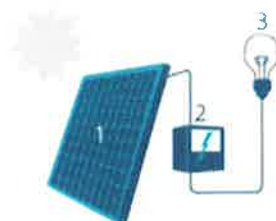
1. Zonnepaneel 2. Omvormer 3. Afname van elektriciteit
