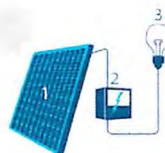
1. Zonnepaneel | 2. Omvormer | 3. Elektrische toestellen
