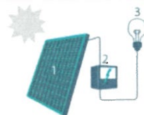
1. Zonnepaneel 2. Omvormer 3. Lichtbolb
