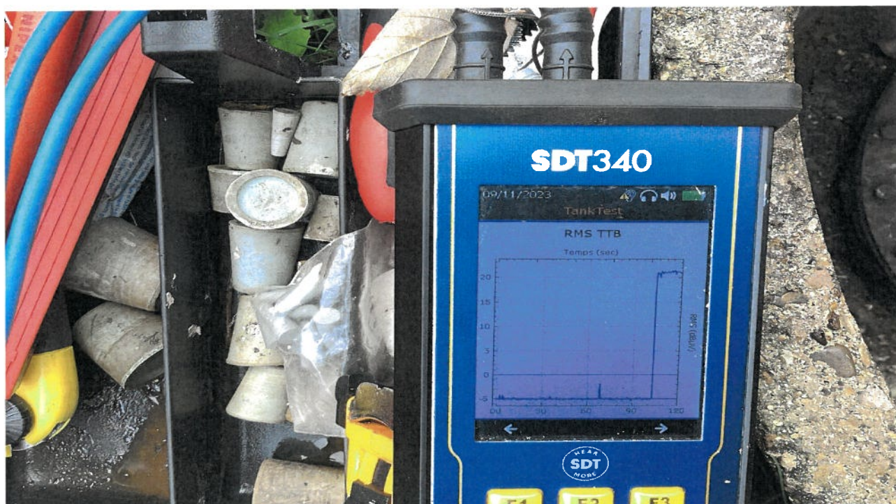
Enregistrement des capteurs avec la fuite calibrée
