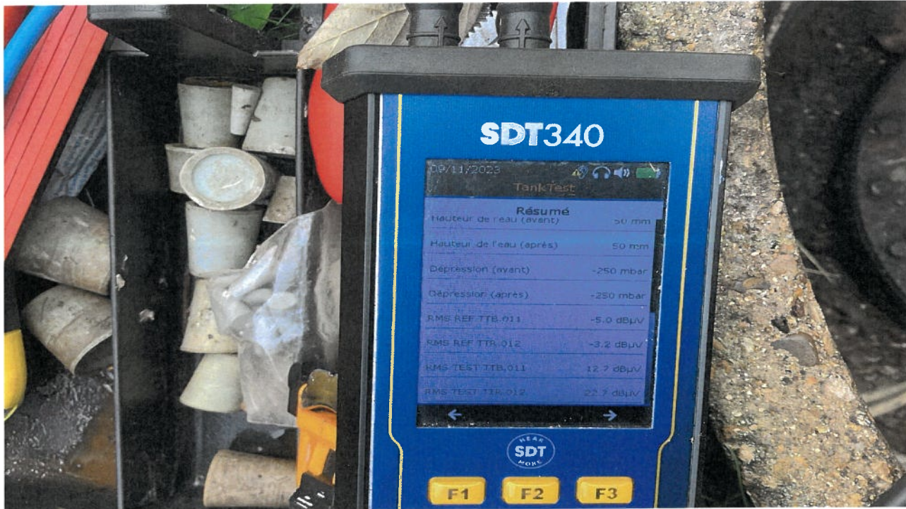
Enregistrement des capteurs avec la fuite calibrée
