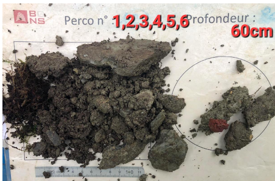
Photo 1 : Sol de nature argileuse à charge schisteuse
