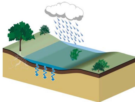
Figure 2 : Exemple de noue d'infiltration
