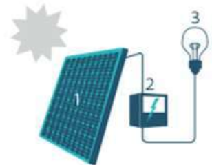
1. Zonnepaneel | 2. Omvormer | 3. Elektrische toestellen
