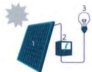
1. Zonnepaneel | 2. Omvormer | 3. Elektrische toestellen
