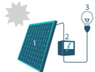
1. Zonnepaneel | 2. Omvormer | 3. Elektrische toestellen
