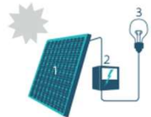
1. Zonnepaneel | 2. Omvormer | 3. Elektrische toestellen
