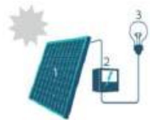
1. Zonnepaneel | 2. Omvormer | 3. Elektrische toestellen
