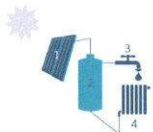
Fig. 2: Zonneboiler op het dak
