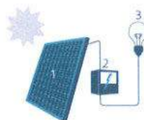
1 Zonnepaneel 2 Elektrische meter 3 Elektrische aansluiting
