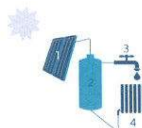
Zonnepaneel, zonnecollector, opslagvat, radiator 1 2 3 4
