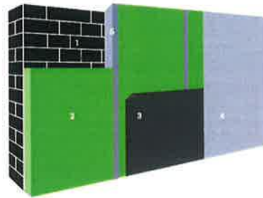
1. Bultengevel | 2. Isolatie | 3. Dampschermb | 4. Binnenafwerking | 5. Stijl- en regelwerk (optioneel)
