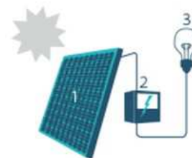
1. Zonnepaneel | 2. Omvormer | 3. Elektrische toestellen
