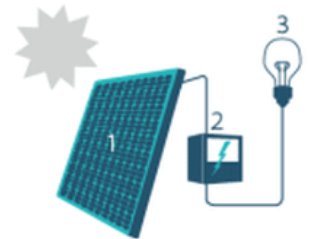
1. Zonnepaneel | 2. Omvormer | 3. Elektrische toestellen
