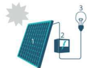
1. Zonnepaneel | 2. Omvormer | 3. Elektrische toestellen
