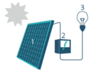
1. Zonnepaneel | 2. Omvormer | 3. Elektrische toestellen
