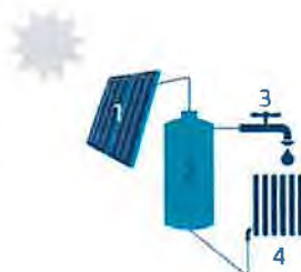
Zonnecollector | 2. Opslagvat 3. Radiator 4. Tap
