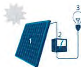
Zonnepanelen | 2. Inverter 3. Elektrische verbruiker
