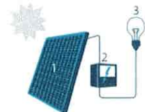
1 Zonnepaneel | 2 Omvormer | 3 Elektrische toestellen
