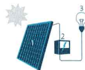
1. Zonnepaneel | 2. Omvormer 3. Elektrische toestellen
