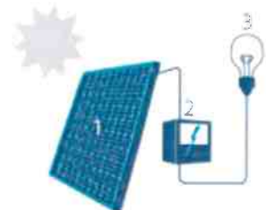
1 Zonnepaneel (2 Omvormer (3 Elektrische verbruiker)
