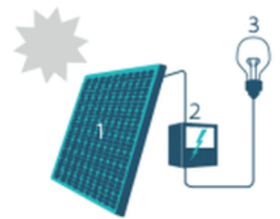
1. Zonnepaneel | 2. Omvormer | 3. Elektrische toestellen
