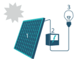
1. Zonnepaneel | 2. Omvormer | 3. Elektrische toestellen
