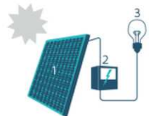
1. Zonnepaneel | 2. Omvormer | 3. Elektrische toestellen
