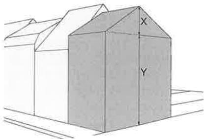
La hauteur verticale entre la sablière et la faîtière (x) est inférieure à la hauteur sous gouttière (y) de la façade principale à rue.
