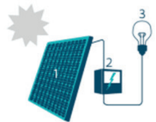
1. Zonnepaneel | 2. Omvormer | 3. Elektrische toestellen
