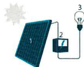
1 Zonnepaneel | 2 Omvormer | 3 Elektrische toestellen
