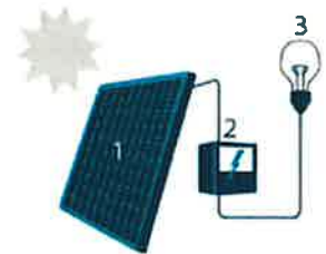
1 Zonnepaneel | 2 Omvormer 3 Elektrische installatie
