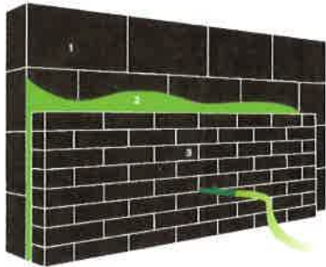
1. Dragende muur | 2. Ingeblazen isolatie | 3. Gevelsteen / gevelbekleding
