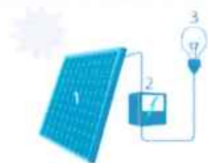
1. Zonnepaneel | 2. Omvormer | 3. Elektrische aansluiting
