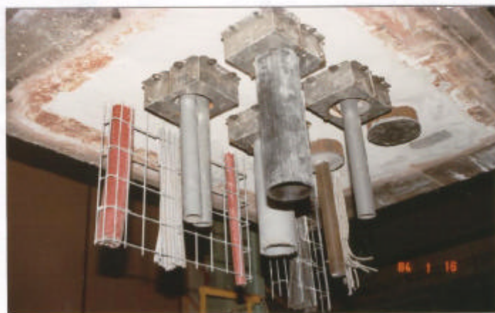
Vóór de proef : de blootgestelde zijde van het proefelement
