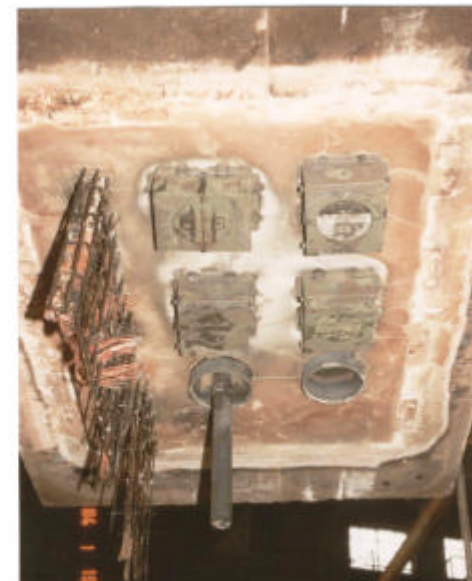
Na de spuitproef : de blootgestelde zijde van de kabel- en buis- doorvoeringen
