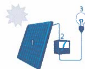
1. Zonnepaneel | 2. Omvormer | 3. Elektrische toestellen
