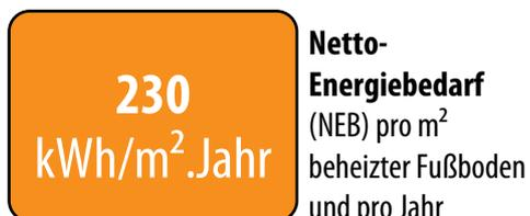
Dieser Bedarf ist die Wärmezufuhr, die von der Heizung bereitgestellt werden muss, um die Innentemperatur der Wohnung konstant zu halten. Er hängt ab von den Verlusten durch die Wände entsprechend ihrer Wärmedämmung, den Verlusten durch mangelnde Luftdichtigkeit, den Verlusten durch die Belüftung, aber auch von den Solarbeiträgen und den internen Beiträgen.
