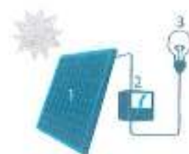
1. Zonnepaneel | 2. Omvormer | 3. Elektrische fitting
