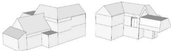
Le volume protégé d'un logement reprend tous les espaces du logement que l'on souhaite protéger des déperditions thermiques que ce soit vers l'extérieur, vers le sol ou encore des espaces non chauffés (cave, annexe, bâtiment mitoyen...). Il comprend au moins tous les locaux chauffés. Lorsqu'une paroi dispose d'un isolant thermique, elle délimite souvent le volume protégé.
