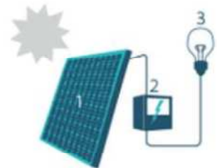
1. Zonnepaneel | 2. Omvormer | 3. Elektrische toestellen
