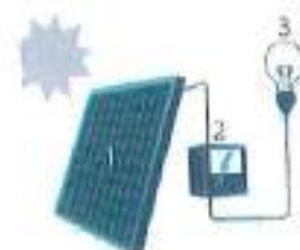
1. Zonnepaneel | 2. Omvormer | 3. Elektrische toestel
