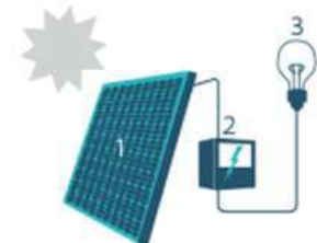
1. Zonnepaneel | 2. Omvormer | 3. Elektrische toestellen
