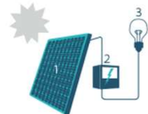
1. Zonnepaneel | 2. Omvormer | 3. Elektrische toestellen
