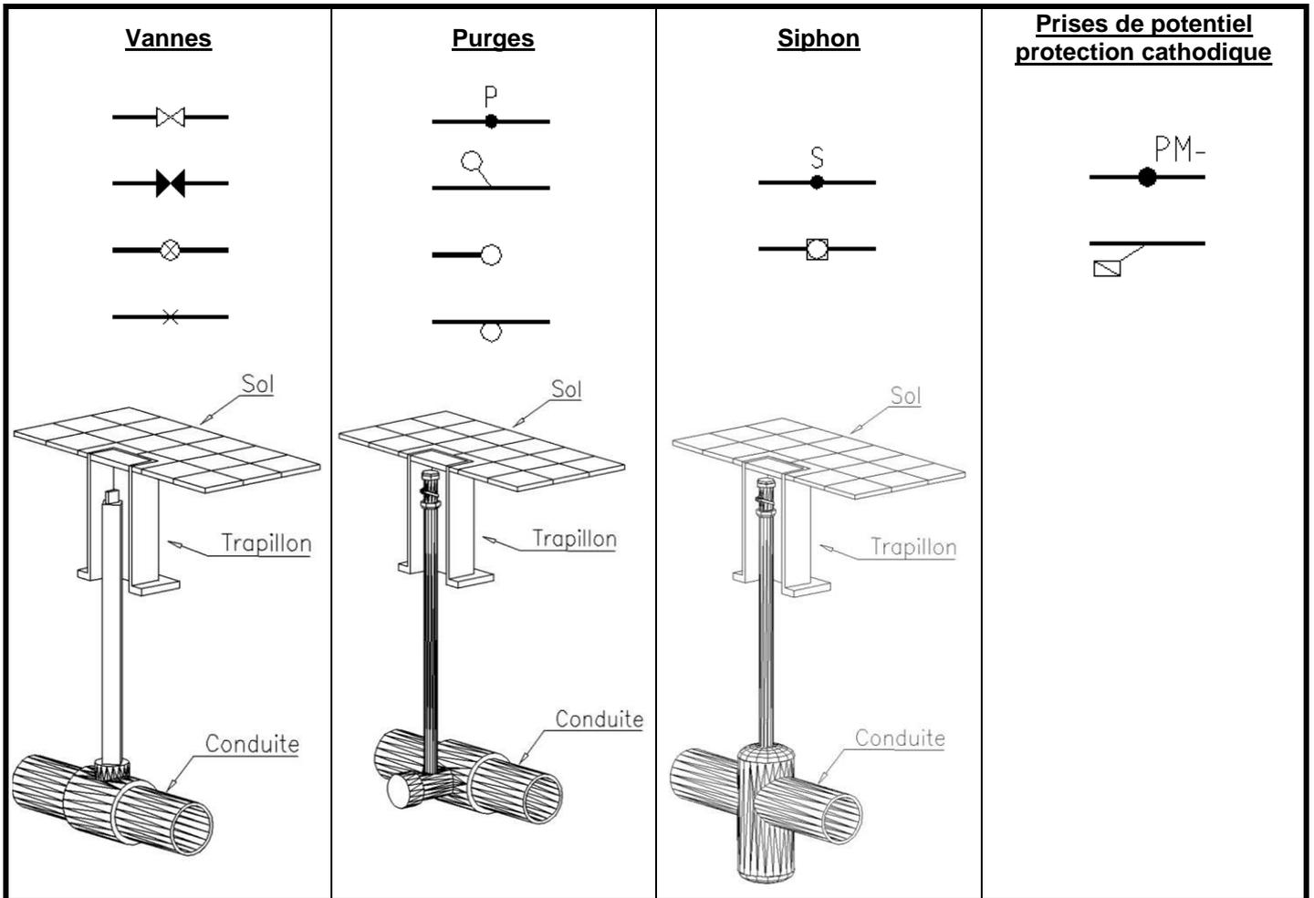
Ces éléments remontent d'office à la surface du sol et sont en principe surmontés d'un trapillon. Toutefois, en fonction des différents travaux qui ont pu avoir lieu après leur pose, ces trapillons peuvent ne plus être visibles et une grande prudence est donc de mise.
