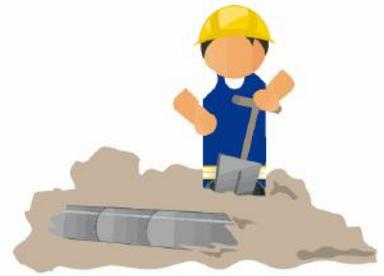
**1.2.** Il y a lieu de tenir compte du fait que les brides et certains accessoires des canalisations et branchements ne sont pas indiqués sur le plan et peuvent remonter à la surface (syphons, vannes, points de mesure de protection cathodique, etc.).
