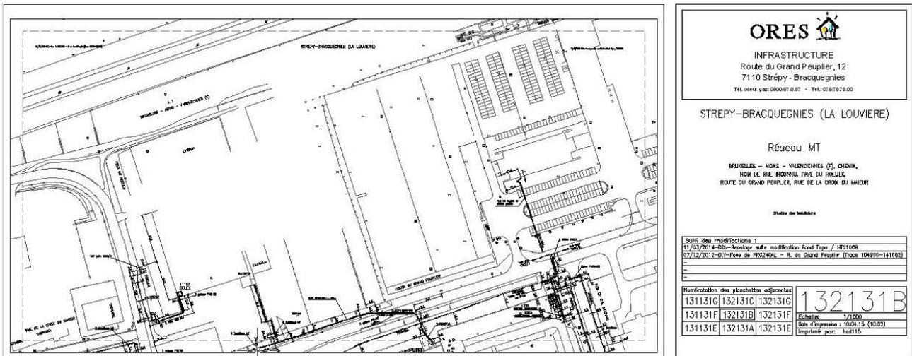
Ces plans, couvrant une zone de 500m x 250m et imprimés à l'échelle 1/1000ème ou 1/500ème en fonction de la densité du réseau, sont identifiés par 6 chiffres suivi d'un indice allant de « A à H ».
