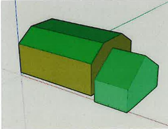
Le volume protégé d'un logement reprend tous les espaces du logement que l'on souhaite protéger des déperditions thermiques que ce soit vers l'extérieur, vers le sol ou encore des espaces non chauffés (cave, annexe, bâtiment mitoyen...). Il comprend au moins tous les locaux chauffés. Lorsqu'une paroi dispose d'un isolant thermique, elle délimite souvent le volume protégé.
