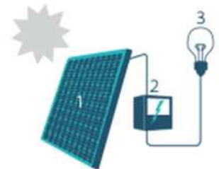
1. Zonnepaneel | 2. Omvormer | 3. Elektrische toestellen
